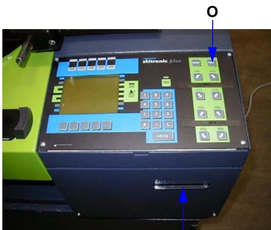
Sind alle Einstellungen für den linken u. rechten Ski bzw. Ferse in Ordnung (Lampen für entsprechende Auslöserichtung müssen leuchten; Pos.2 u. 3), wird eine Einstellkarte in den an der Gerätevorderseite liegenden Schlitz (1) geschoben und mit der Taste Print (O) der Druckvorgang gestartet.
