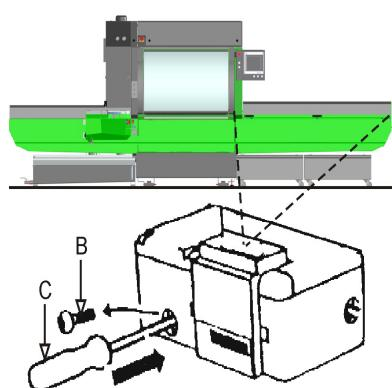
Otevření pomocí nouzového odblokování je povoleno výhradně při výpadku napětí (pokud nutné) nebo v případě vady dveřního spínače.
