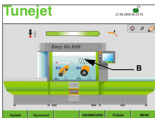
Dotykem na symbol struktury [B] na hlavní obrazovce se otevře okno pro výběr struktury.
