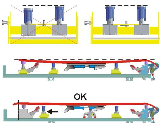
Opěry lyží nastavit vlevo a vpravo na stejnou výšku (s výjimkou individuální opravy přitlaku u snowboardů).
