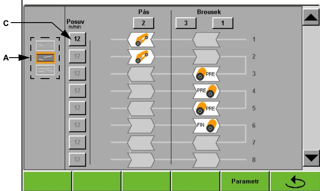
V tomto příkladě bylo předbroušení kamenem změněno na 3 zpracování. Průběh zpracování se přizpůsobí automaticky.
