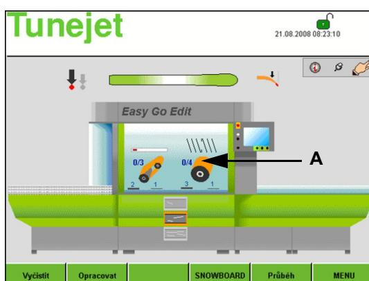
Dotykem na symbol brusného kamene [A] na hlavní obrazovce se otevře okno "Parametry počtu otáček".
