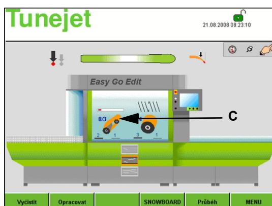
Dotykem na symbol pásu [C] na hlavní obrazovce se otevře okno "Parametry počtu otáček".
